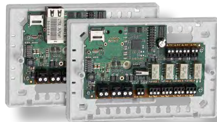
TSE Türmanager mit RS485 oder XPort (Ethernet) TSE door manager with RS485 or XPort (Ethernet)
